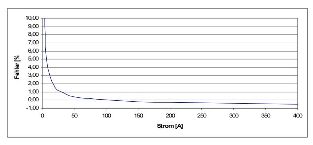
Daraus ist ersichtlich, dass selbst bei 10A (=2.5% des Nennstromes von 400A) der Messfehler bei 3,4% liegt; das entspricht einem EVU-Zähler der Klasse A (=3,5%-Fehler).
