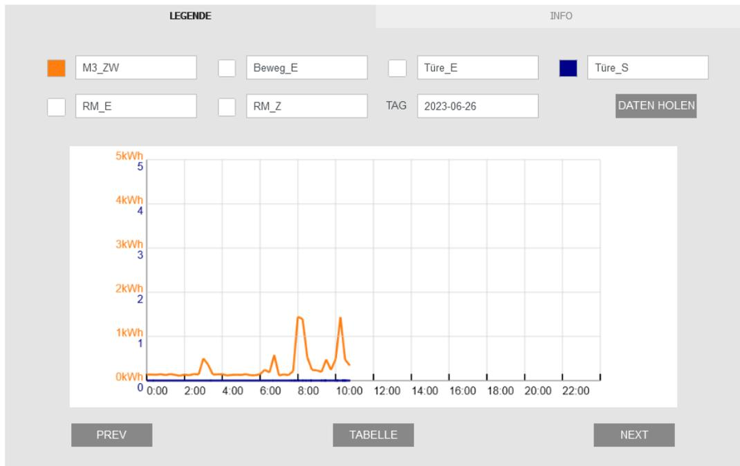
**DATENPUNKTE:** Beliebige Datenpunkte des Gerätes aus den Drop-Down-Listen wählen, durch Anklicken der Schaltfläche 'DATEN HOLEN' die neue Daten laden. Danach kann durch Anklicken der quadratischen Fläche links neben dem Datenpunkt die Anzeige ein- und ausgeschaltet werden.
