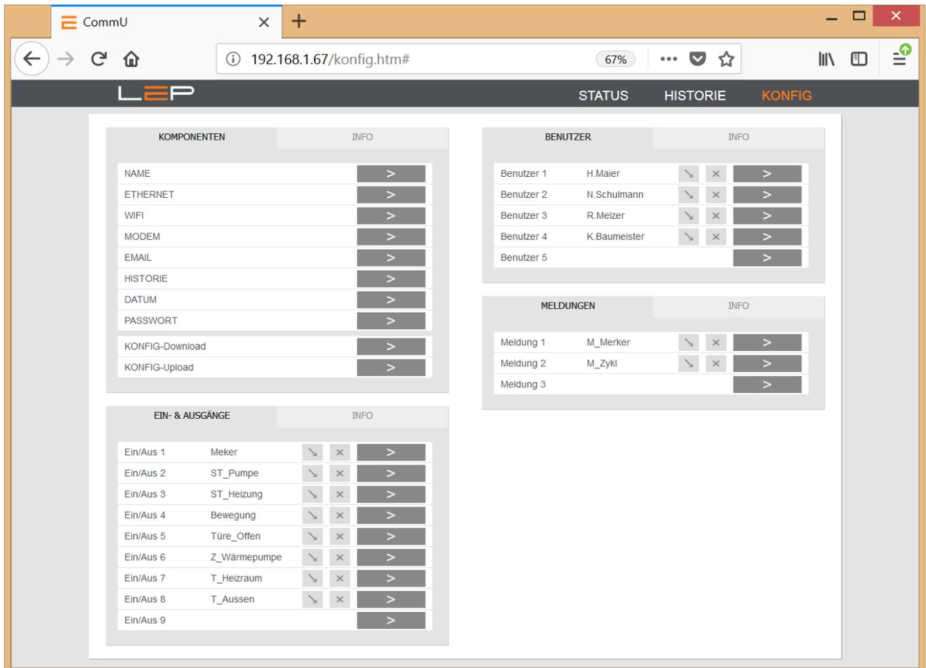
**KOMponenten:** Parametrierung der einzelnen Hardwarekomponenten / Funktionen des Gerätes
