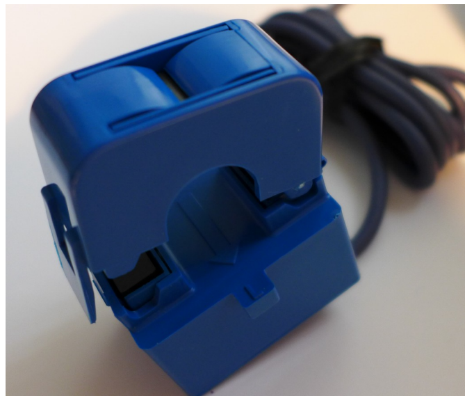
Abbildung 3: Richtige Durchsteckrichtung des Primärleiters (siehe Pfeil innen) und zusätzliche Markierung durch „K“ und „L“
